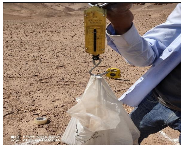
D. Pesaje de las muestras de suelo.
