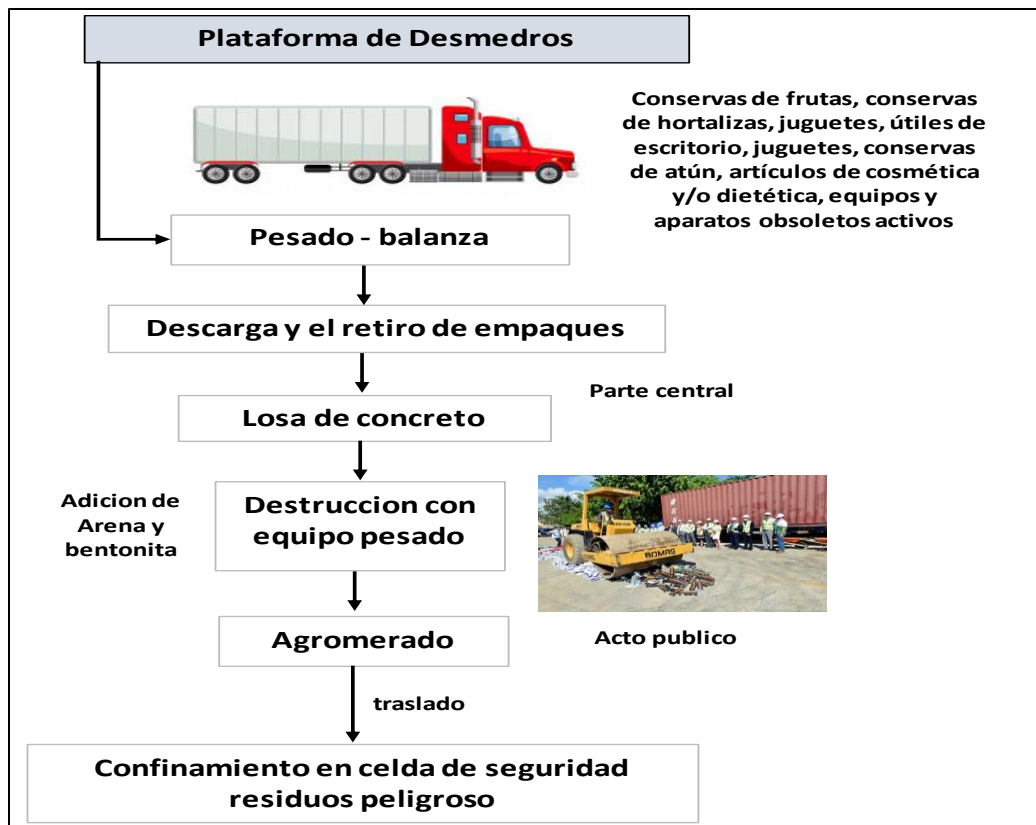
Esquema N° 5.10.3- 9: Diagrama de flujo del proceso de tratamiento de destrucción de desmedros
